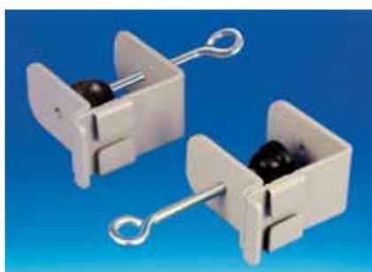
Porte-fronton serre-joint se fixant sur tous types de tablettes de 3 à 30 mm. Permet de recevoir des clips porte-fronton de 3 et 5 mm droit ou incliné (non livré). Possibilité de positionner la vis de serrage en bas ou en haut de la pièce (pour la dissimuler derrière le panneau).
